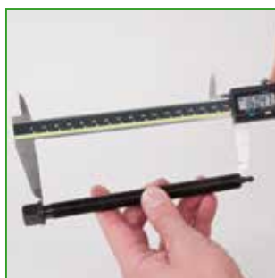
b Измерить длину резьбы до наконечника шпинделя.
