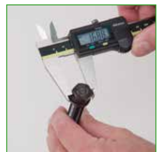
d Измерить шестигранник головки шпинделя.
