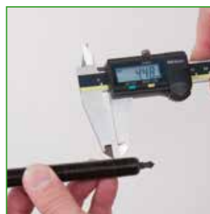
c Измерить длину сверх трех витков резьбы.
