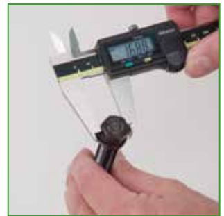
d Измерить шестигранник головки шпинделя.
