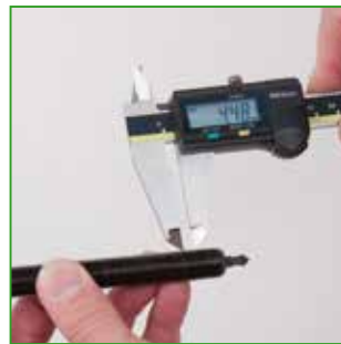
c Измерить длину сверх трех витков резьбы.
