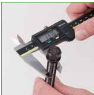
a Измерить диаметр шпинделя
