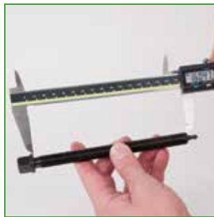
b Измерить длину резьбы до наконечника шпинделя.
